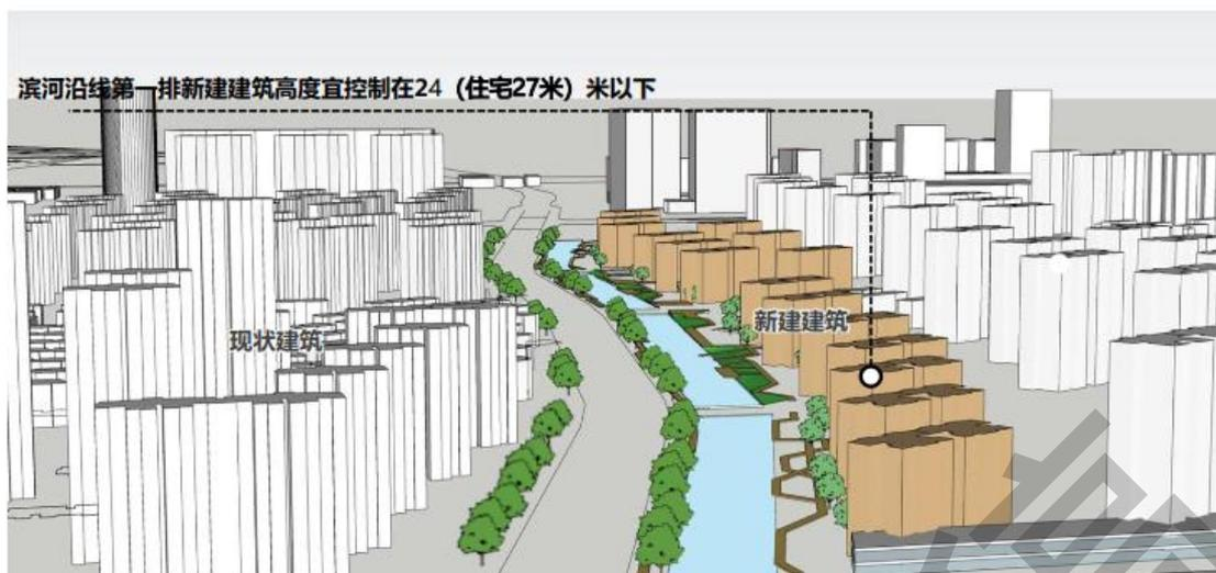
图16 滨河建筑高度控制示意图
